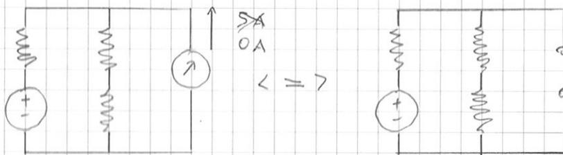
Annullare un generatore di corrente significa portare a 0A la sua corrente. Ciò è equivalente ad aprire il circuito.
