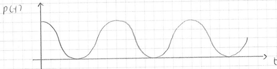
Quando la tensione ha un picco anche la potenza attiva ha un picco. Analogamente quando la tensione passa per lo zero anche la potenza attiva è nulla. La potenza attiva ha frequenza doppia rispetto a tensione e corrente.
