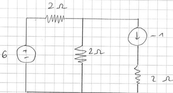
Sostituire il generatore reale di tensione con un generatore reale di corrente e applico il partitore.
