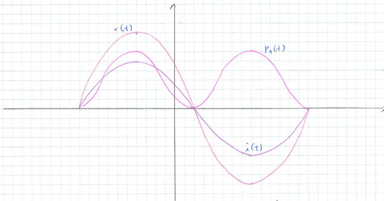
Otengo, facendo il prodotto, una sinusoide di frequenza doppia. Ho un off-set che mi sposta la potenza verso l'alto (potenza attiva, sempre positiva), poi ho una sinusoide di frequenza relativamente alta.  $P(t)$  è una sinusoide di frequenza doppia rispetto a tensioni e correnti.
