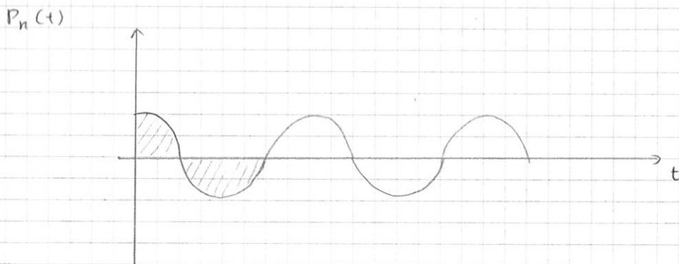
La parte reattiva della potenza non fa altro che accumulare e cedere energia, accumulare e cedere, accumulare e cedere... Rimpallata energia e basta. Il valore medio è nullo. C'è uno scambio continuo di energia tra componenti reattive e generatori.
