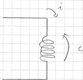
Un induttore è un componente che, quando al suo interno passa una corrente  $i$ , genera al suo interno una f.e.m. e che si oppone alla variazione di corrente.
