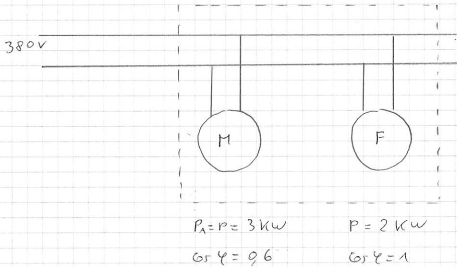
Guardiamo qual è il fattore di potenza complessivo dell'impianto. Scriviamo una tabella in cui mettiamo la potenza in kW, l'angolo  $\varphi$  e la potenza reattiva in kVAr e il  $\cos \varphi$ .
