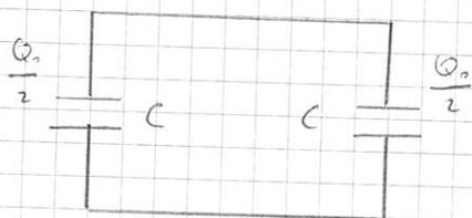
energia immagazzinata :  $E = \frac{1}{2} \left( \frac{Q_0}{2} \right)^2 \frac{1}{C} + \frac{1}{2} \left( \frac{Q_0}{2} \right)^2 \frac{1}{C} = \frac{Q_0^2}{4} \cdot \frac{1}{C}$
