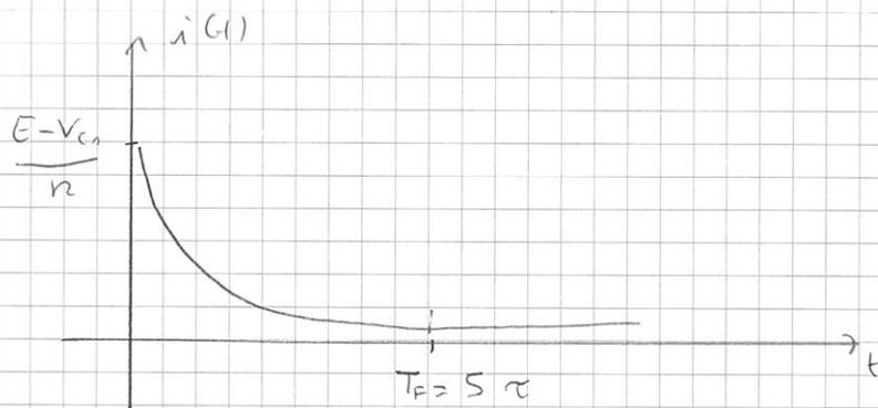
Mano a mano che il condensatore si carica la corrente diminuisce fino a diventare trascurabile. Al tempo  $T_F$  essa si è ridotta del 93%.
