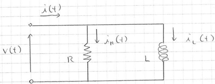
La componente in fase è quella che va sulla resistenza, quella in quadratura va sull'induttanza.
