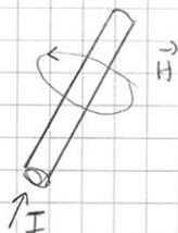
Immaginiamo che il filo conduttore sia un cilindro di raggio R. Lungo questo cilindro in direzione assiale avremo una densità di corrente costante uniforme j.
