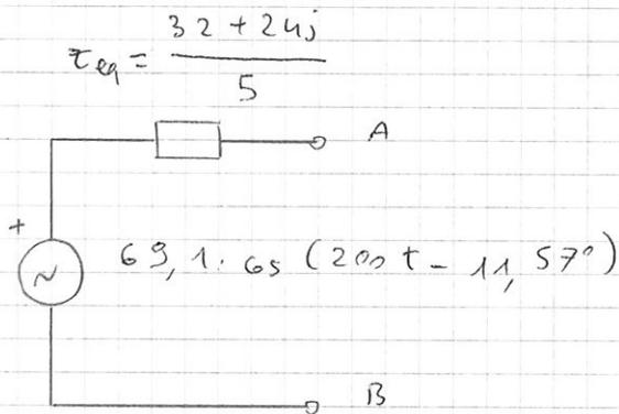
Questa impedenza complessa  $z_{eq}$  la posso sostituire con la serie di una resistenza e di una induttanza.
