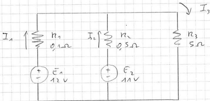
Immaginiamo che i 2 generatori siano due batterie, una più scarica ( $E_2$ , poiché ha tensione più bassa e resistenza più alta) e una più carica. Supponiamo che  $R_3$  sia un carico (ad es. una torcia). Abbiamo calcolato la tensione ai capi di  $R_3$  e:
