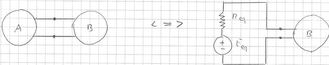
Prese una rete qualsiasi formata solo da generatori ideali e resistenze è possibile sostituirla con una rete equivalente formata da un generatore di tensione ideale con in serie una resistenza.
