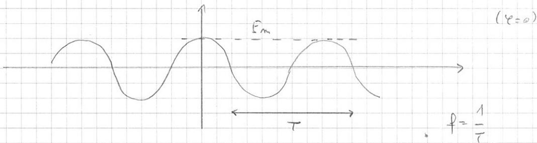
Tutte le altre Tensioni e correnti del circuito saranno di tipo sinusoidale. Quindi possiamo ipotizzare un andamento di questo tipo
