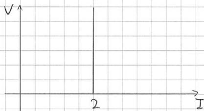
Non riesco nemmeno a convertirlo in un generatore di tensione perché non ho una resistenza in parallelo
