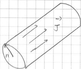
Calcoliamo l'intensità del campo all'interno del conduttore.
