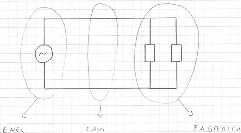
Una parte della potenza fluttuante, che l'ENEL non darebbe conteggiata, in realtà viene dispersa lungo i fili. Il fornitore ha perciò fissato dei parametri minimi per  $\cos \varphi$ .
