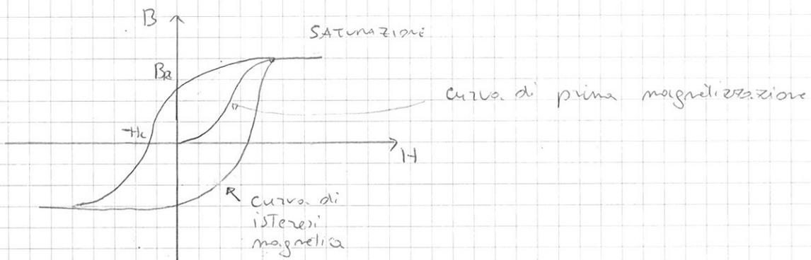
Quando tutti i domini si sono orientati, anche aumentando  $H$   $B$  non può più aumentare, il materiale è saturo. Ora se diminuisco  $H$  ottengo una curva un po' diversa. Quando  $H=0$   $B$  non si annulla, ma assume un valore  $B_r$  detto magnetizzazione residua. Se voglio annullare  $B$  devo applicare un campo magnetico  $H_c$  detto coercitivo. Una cosa analoga la ottengo aumentando di meno  $H$ .
