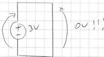
Il metodo di Maxwell alle maglie non si può applicare così meccanicamente per ispezione. Il problema è sempre che  $V_A$  è già noto ( $V_A = 3V$ ).
