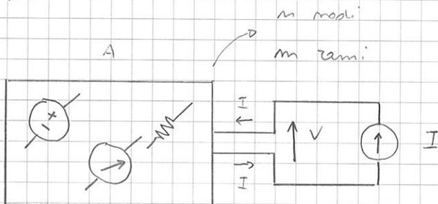
Colleghiamo i morsetti del circuito A ad un generatore ideale di corrente. Tra i due morsetti si genera una ddp  $V$ . La corrente che esce da un morsetto è la stessa che entra nell'altro ( $I$ ).
