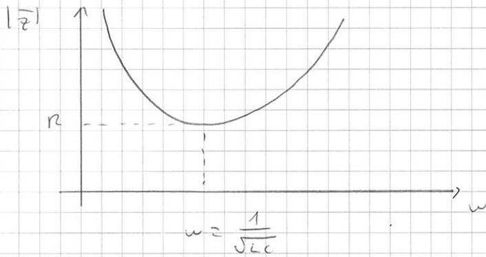
In particolare in questo caso l'impedenza è puramente resistiva  $\Rightarrow$  tensione e corrente risultano in fase.
