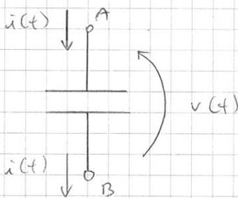
Immaginiamo di buttare una certa corrente nel condensatore. Come è possibile avere la stessa corrente dall'altra parte se in mezzo al condensatore c'è un isolante? Suppongo che quando entra corrente (positiva) dal morsetto A esce una stessa corrente (negativa) dall'altra parte. C'è un circuito intorno per cui se un elettrone entra da una parte uno esce dall'altra. In questo caso viene rispettata la conservazione della carica.
