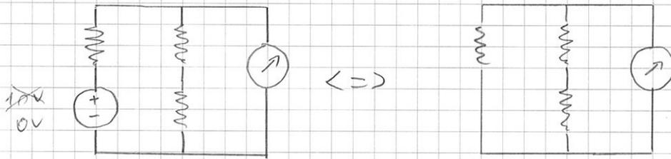
Annullare un generatore di tensione significa mettere il suo potenziale a 0V. Un potenziale a 0V corrisponde a un cortocircuito.
