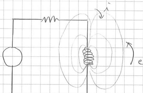
Di solito le induttanze sono costituite con molte file avvolte intorno a un toroide di materiale ferromagnetico, la maggior parte del campo è tutta qua dentro.
