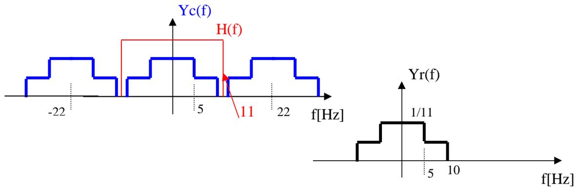
Il segnale  $y_r(t)$ , all'uscita del filtro di ricostruzione ideale, viene ricostruito con la stessa forma del segnale continuo originario  $y(t)$  solo nel caso c), corrispondente ad un campionamento che soddisfa il criterio di Nyquist  $f_c > 2B$ , dove  $B=10\text{Hz}$  e' la banda del segnale originario.
