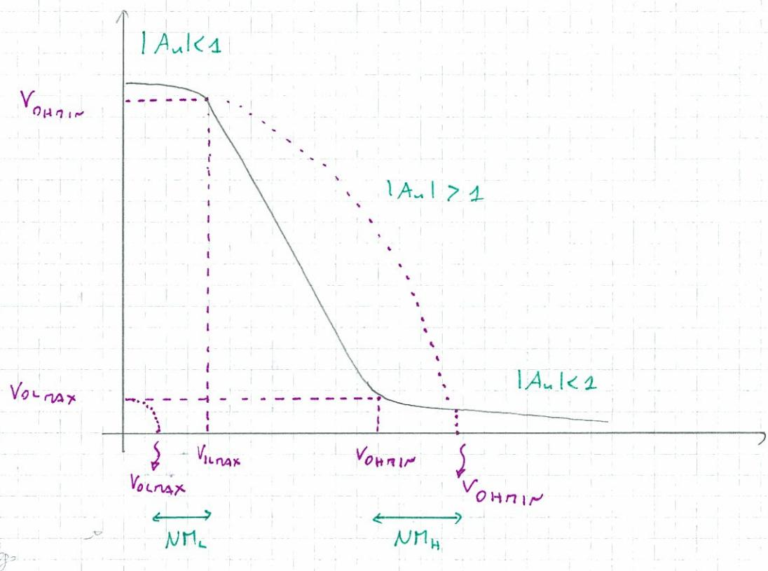
$$NM_L = V_{ILMAX} - V_{INMAX}$$
