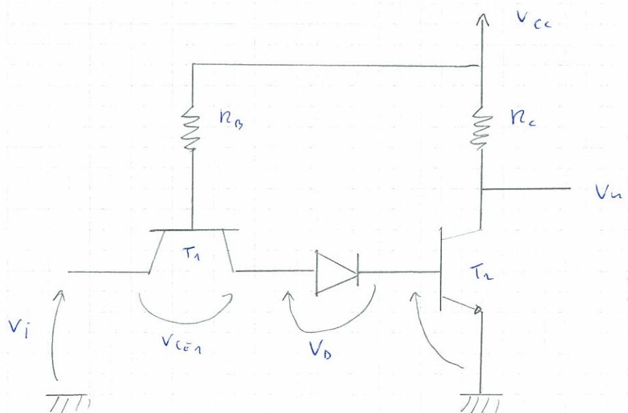
Aggiungo un diodo. Per varicare  $NM_H$   $V_{IL\max}$  mi interessa il passaggio
