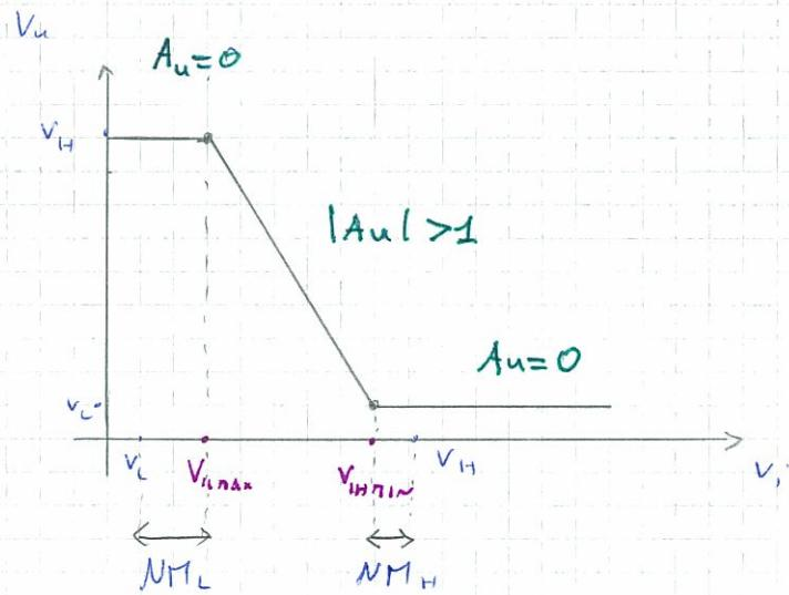
Per je cas baso posso lavorare al massimo su un solo  $V_{I_{H\max}}$  e non su un altro su un minimo su un solo  $V_{I_{L\min}}$  (e' il primo valore alto riconosciuto come tale, userò in prob di darmi un'uscita Bassa).
