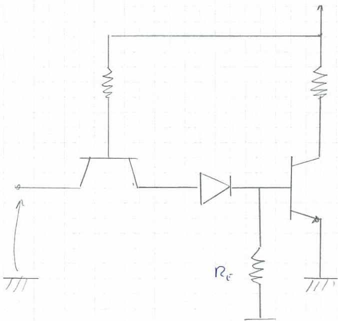
Un'altra soluzione c'è cercare di avere ingresso alto e uscita bassa senza desaturare i transistor. Dobbiamo introdurre un'altra logica.
