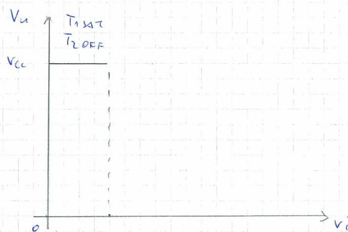
Per un ingresso basso sappiamo del dispositivo  $T_1$  SAT e  $T_2$  OFF.
