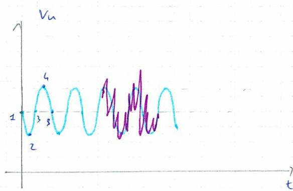
In uscita ottengo un segnale sinusoidale amplificato e invertito.
