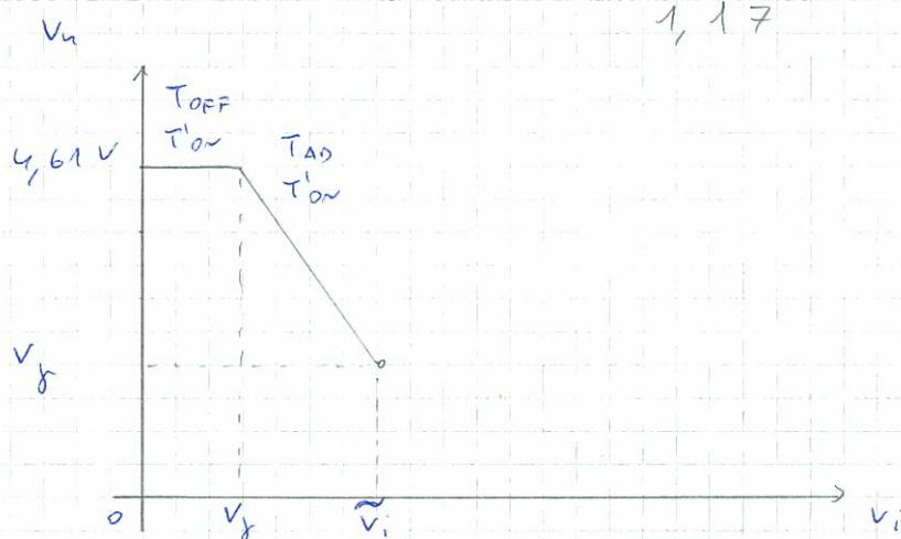
Ma se  $T'$  va off torniamo esattamente nella condizione dell'altra volta del transistore  $T$  che non ha carico.
