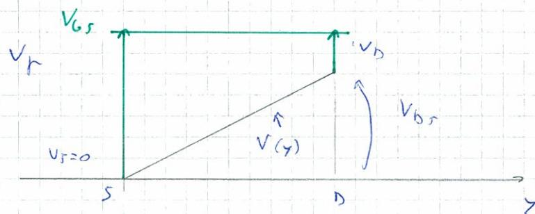
Il canale è più lungo della parte di S e più piccolo della parte di D, perché qui la caduta di potenziali  $V(y)$  è più piccola
