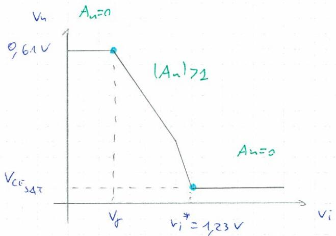
$$V_{OL,\max} = V_{CE,SAT}$$
