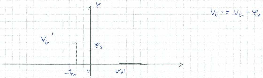
Per passare da  $V_G'$  a 0 il potenziale deve diminuire (vedremo). A noi interessa il potenziale  $\varphi_s$  all'interfaccia Si-SiO<sub>2</sub>.
