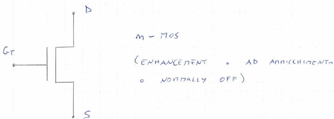
G<sub>T</sub> = Gate. Gli altri due terminali sono scambiabili (cioè non ha una struttura simmetrica).
