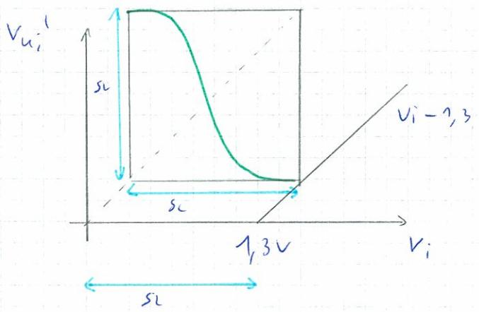
Da ora non avrò altri ECL mesi in scadenza. Questo mi potrebbe dare dei problemi. Per evitare al punto del diodo metto un bipolare.
