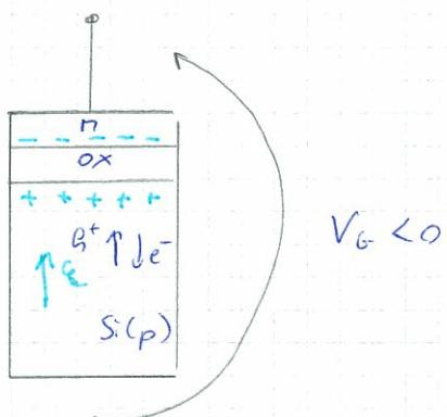
Sono in una regione di funzionamento chiamata ACCUMULAZIONE. Sto accumulando lacune all'interfaccia.
