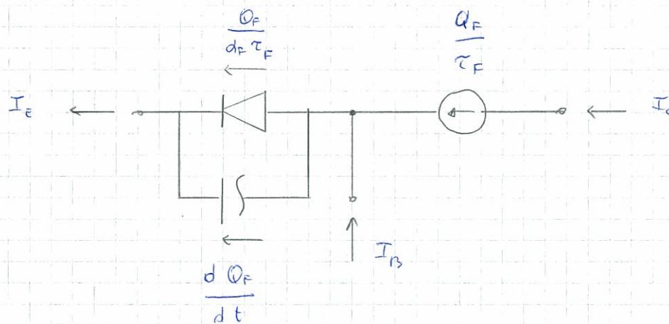
Scelgo di trascurare le capacità associate alle giunzioni, perché vedremo che sono trascurabili.
