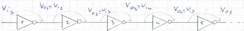
Se anziché  $V_{i_1}$  in ingresso ho  $V_{i_1} + \Delta$  con  $\Delta$  un valore comunque un po' di sotto del vero riconosciuto come alto (sebbene non sarà esattamente  $V_{HIGH}$ ). Questo diventerà l'ingresso del secondo inverter. Ne resta.
