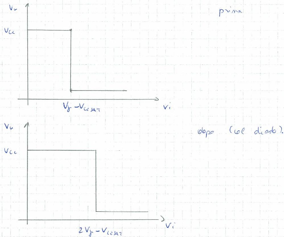
Ma ora quando voglio spegnere devo spegnere non solo il transistor, ma anche il diodo. Dobbiamo aggiungere una resistenza per avviare a questo problema, con la quale scaricano. Ma in questo modo torniamo a un HTC. L'unica soluzione è cambiare ~~la~~ la rete. Si usano TIC più complicati, che però non vogliono.
