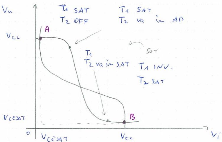
Non B dimostrano, ma da A a B i transistori cambiano regione di funzionamento.
