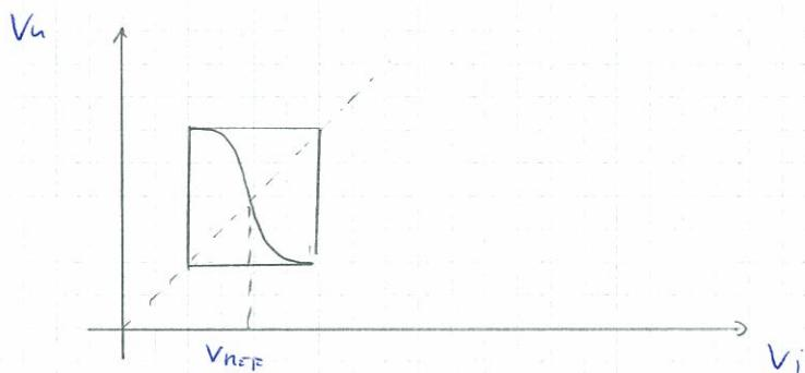
$$V_u = V_{EE} - \frac{n I_o}{\frac{V_{NCF} - V_i}{V_T}}$$
