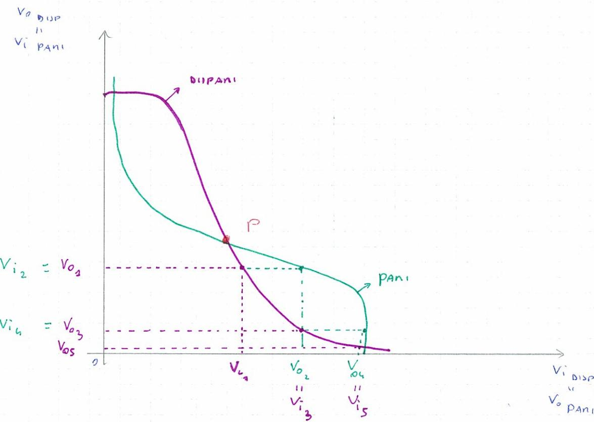
Siano partiti da un ingresso del 1° transistor in regione emettitrice. Dopo un certo # di inversioni l'uscita  $V_{os}$  è rientrata dentro i margini, e' tornata un valore basso, dopo un numero basso di passaggi di inversioni.
