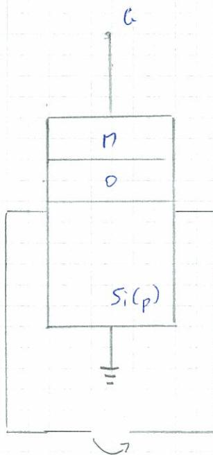
Una volta che avrai capito come si varia il campo basterà applicare una differenza di potenziale per generare corrente. Questo condensatore avrà una capacità variabile.
