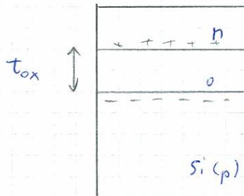
Perché in suonato la capacità sarà la capacità associata all'ossido meno la capacità della regione suonata.
